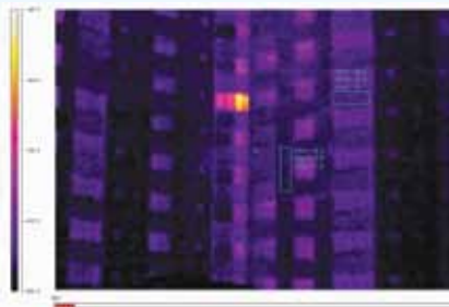
Фото 1. Дом с тепловентилируемым фасадом построен и введен в эксплуатацию компанией «ДСК-4» в 2010 году в Киеве по ул. Закревского, 97. Съемка тепловизором свидетельствует о незначительных потерях тепла
