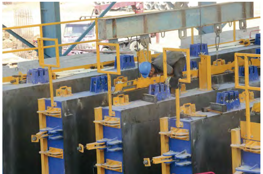
Рис. 6. Механические зажимы на отсеках кассетной формы для простой манипуляции и удешевления технического обслуживания
