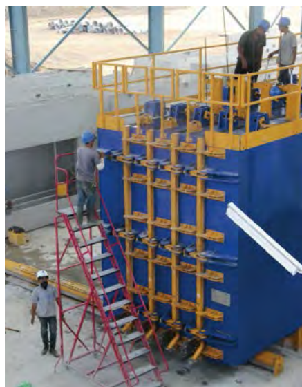
Рис. 6. Механические зажимы на отсеках кассетной формы для простой манипуляции и удешевления технического обслуживания
