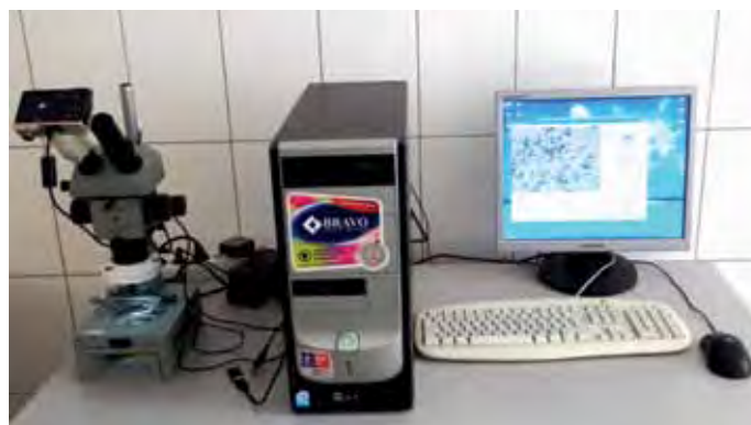
Аналитическая лаборатория АО «ЕВРОЦЕМЕНТ-УКРАИНА», прибор для определения содержания гранулированного доменного шлака в цементе методом компьютерной микроскопии
