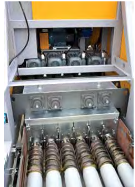
Экструдированная часть с независимыми моторами привода внешних шнеков
