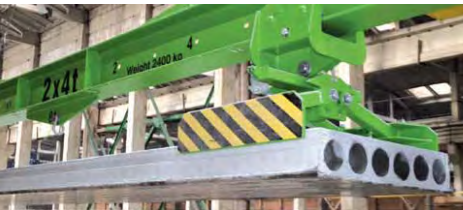
Многопустотные плиты безопалубочного формования выпускаются на оборудовании Elematic
