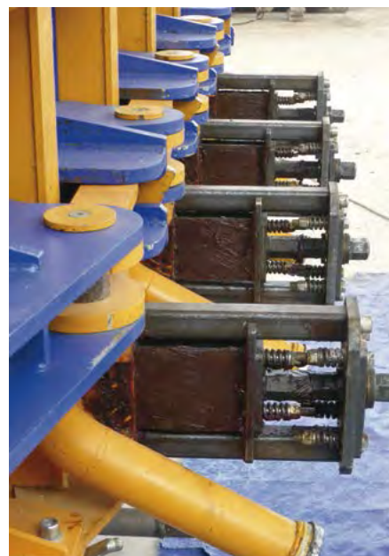
Рис. 11. Бетон подается через специальные насосные соединения, кото-рые не оставляют следов на поверхности конструктивного элемента
