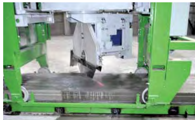
Установка распиловки плит позволяет выпускать нестандартные изделия
