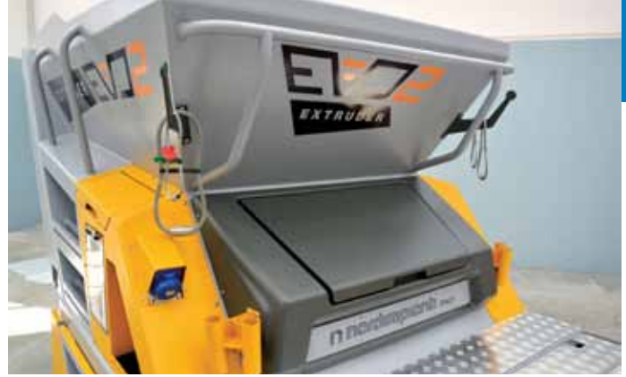
Хранение подъемных петель на специально предусмотренных консолях
