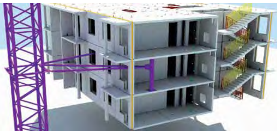
Система крепления отдельно стоящего башенного крана пристежками к плитам перекрытия дома
