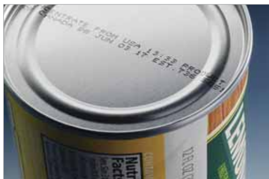
Стр. 44. Помимо предоставления стандартной информации о сроке годности, маркировка помогает выполнить растущие требования к обеспечению прослеживаемости продукции
