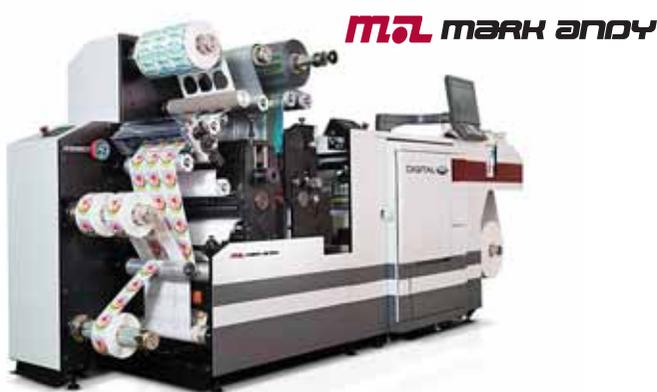
Важным преимуществом машины является широкий ассортимент материалов шириной 330 мм, включая часто используемые в этикеточном производстве бумагу, PP, винил и другие подложки без праймера или покрытия. Максимальная скорость печати – 18,9 м. Простой и удобный RIP позволяет печатать PDF-файлы одним нажатием кнопки.
